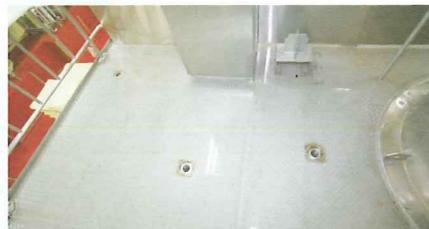
煮終えるたびに圧力釜を水で洗浄する。そのため釜のある床はステンレスで、水が流れ排水管もついている。1日の製造が終わったら、2時間かけて掃除と洗浄をする。また、毎週金曜日は機械を分解しての徹底洗浄とメンテナンスを行っている。
