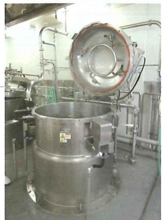
洗浄・浸漬を終えた小豆を180kgずつステンレスの足場の上にある圧力釜で炊く。生産量に比例するが、今は1日平均6釜炊くこと。現在は羊羹の餡のみ製造。4年計画で、最中の餡、残月(焼菓子)の餡、和菓子の餡用の釜を設備していく予定。釜は御殿場工場が300kg炊きなので京都の方が少し小ぶり。
